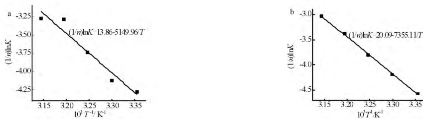
图 7 MnCO 3 晶核形成(a)和晶体生长(b)阶段 (1/n) \ln K \sim 1000/T 曲线
